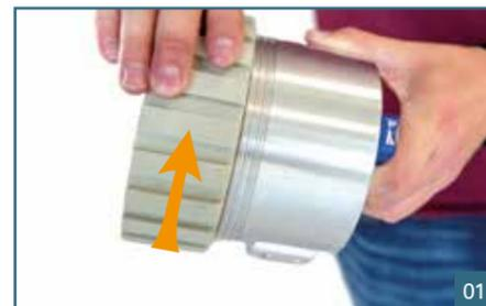
Lösen Sie die Überwurfmutter der Anfasglocke durch Drehen gegen den Uhrzeigersinn.
