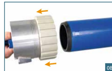
Dann legen Sie das Werkzeug zur Seite, halten die Anfasglocke am Haltegriff und lösen die Zentrierung durch Drehung der Überwurfmutter entgegen dem Uhrzeigersinn. Danach ziehen Sie die Anfasglocke vom Rohrende und entfernen alle Spänereste.
