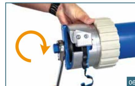
Setzen Sie das Werkzeug auf den Sechskant (SW 24) der Anfasglocke. Beginnen Sie mit dem Anfasen des Rohres, indem Sie die Anfasglocke mithilfe des Werkzeuges im Uhrzeigersinn drehen. Während der Drehung unterstützen Sie mit der anderen Hand die Glocke und üben leichten axialen Druck in Richtung des Rohres aus.
