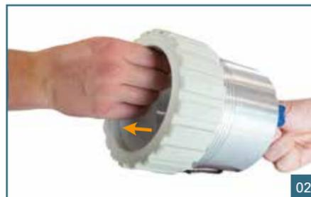
Ziehen Sie anschließend die innenliegende Klemmhülse bis zum Anschlag nach vorne. Dadurch wird die Zentrierung geöffnet.
