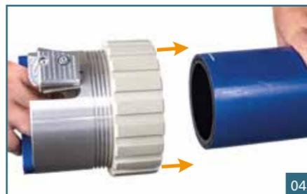
Schieben Sie nun die Anfasglocke auf das Rohrende, bis die Klinge das Rohr berührt. Durch das Sichtfenster neben der Klinge ist die aufgetragene Markierung zu sehen.
