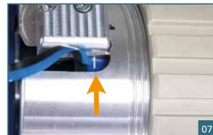
Der Span wird durch das Sichtfenster nach außen geführt. Die erforderliche Fasenlänge ist hergestellt, sobald die Markierung vom Span erreicht ist.
