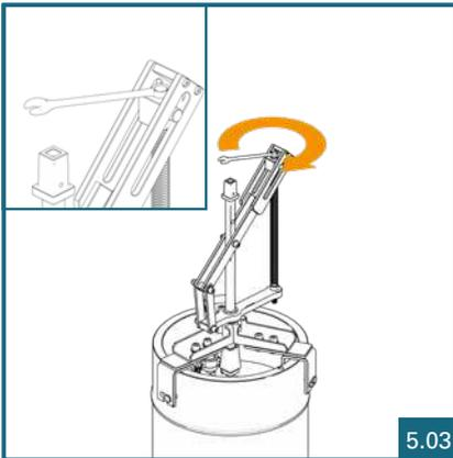
Mit 16 mm Schraubenschlüssel die Schraubstange im Uhrzeigersinn drehen, um den Bajonettverschluss nach unten zu pressen.
