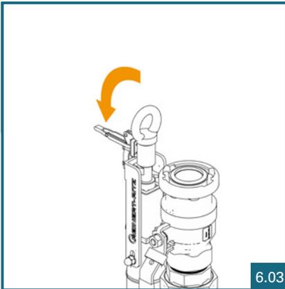
Hebel der Hebehilfe betätigen, um die Verriegelung zu sichern.
