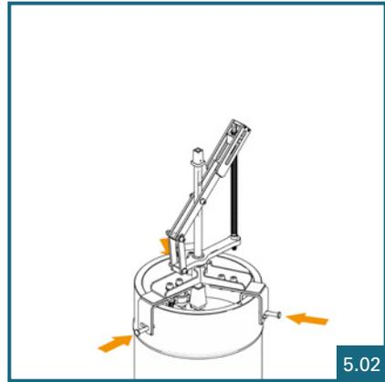
Einpressvorrichtung mit Bolzen an der Molchstation befestigen.
