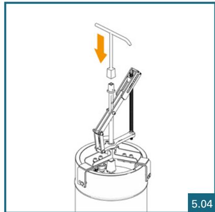
Hydrantenschlüssel C32 auf Vierkantadapter stecken.
