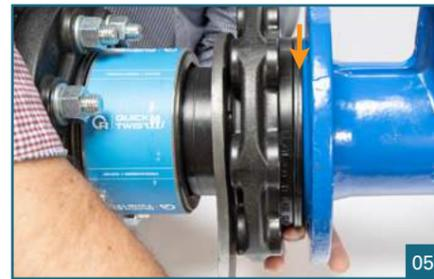
Bringen Sie die Profildichtung in die richtige Position am Armaturenflansch und stellen mit einer **Drehbewegung den HP-Flansch des QUICK-TWIST soweit zu**, dass die Profildichtung soeben gehalten wird.
