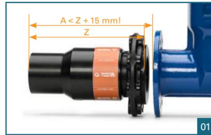
Stellen sie sicher, dass der maximale Verstellweg des QUICK-TWIST (+ 15 mm im Standard) ausreicht, um den Montagepalt zu überbrücken und die Flanschverbindung zur Armatur herstellen zu können. Berücksichtigen Sie dabei auch die Dicke der Profildichtung.
