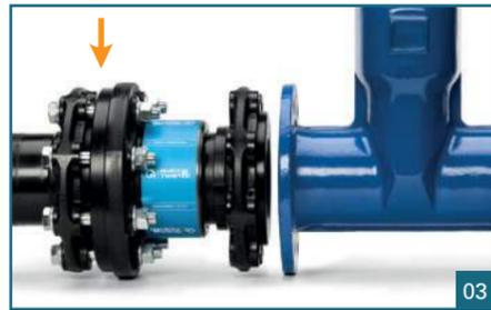
Montieren Sie **zuerst die Festflansch-Seite (Sonderflansch VP)** des QUICK-TWIST am Gegenflansch. Eine Profildichtung ist hierfür nicht erforderlich, da eine O-Ring-Dichtung vorhanden ist.
