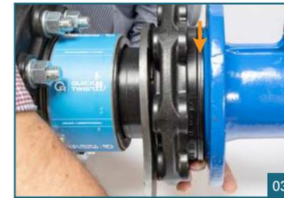
Bringen Sie die Profildichtung in die richtige Position am Armaturenflansch und stellen mit einer **Drehbewegung den HP-Flansch des QUICK-TWIST soweit zu**, dass die Profildichtung soeben gehalten wird.
