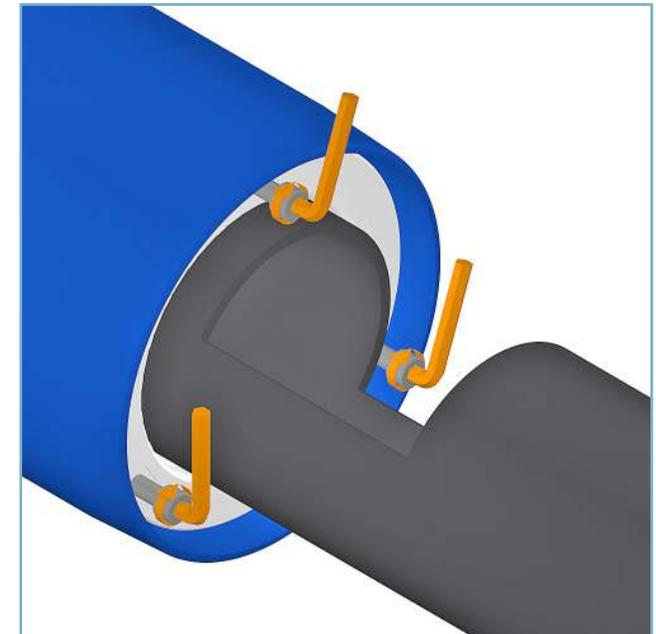
12. Drehen Sie abwechselnd in drei Schritten alle Schrauben fest, bis der weiße Ring bündig mit dem Ende der Muffe abschließt.
