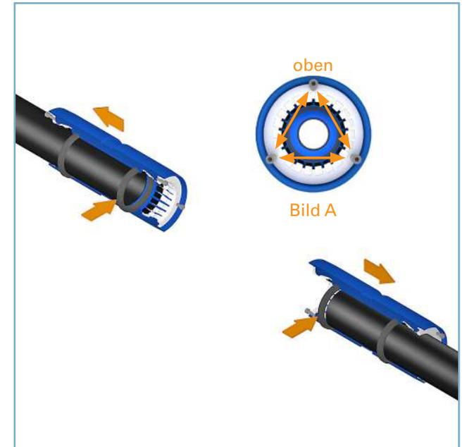
5. Schieben Sie die Reparaturkupplungen bis zur zweiten Dichtung auf die jeweiligen Rohrenden. Achten Sie dabei auf die Stellung der Schrauben (Bild A).
