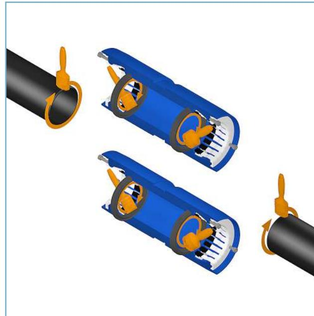
4. Bestreichen Sie die innenliegenden Dichtungen und die angefassten Rohrenden mit Gleitmittel. Bei Trinkwasserleitungen nur Gleitmittel mit DVGW Zulassung verwenden.
