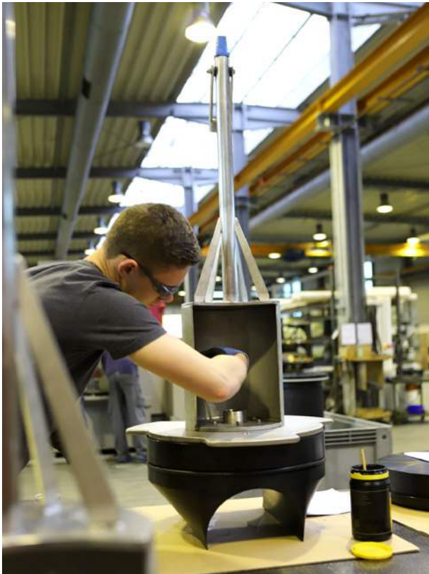
Bild 2: Montage des Sender-Einsatzes für eine Quick-Pig-Molchstation
