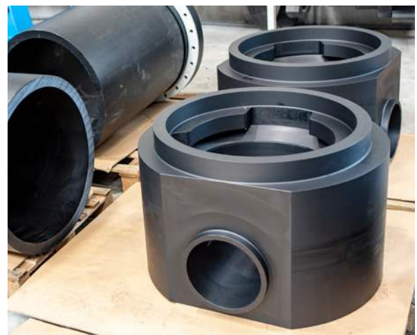
Bild 1: Gefräster Grundkörper der Reinert-Ritz Molchschleuse Quick-Pig
