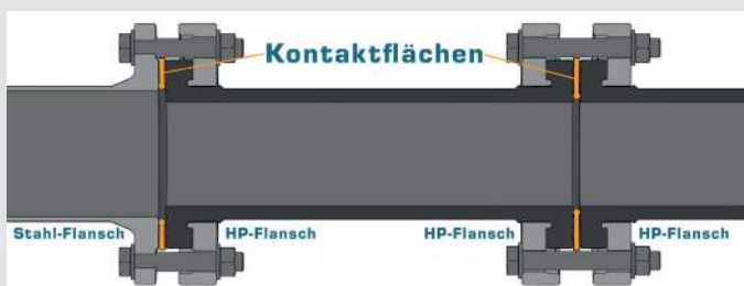
Bild 5: Effektive Dichtflächen an verschiedenen Flanschverbindungen
