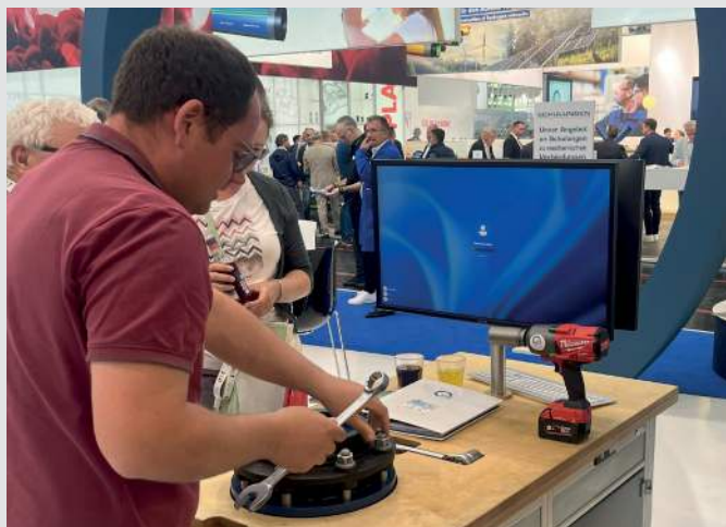
Bild 10: Flanschmontage mit Ring-Maul-Schlüssel
